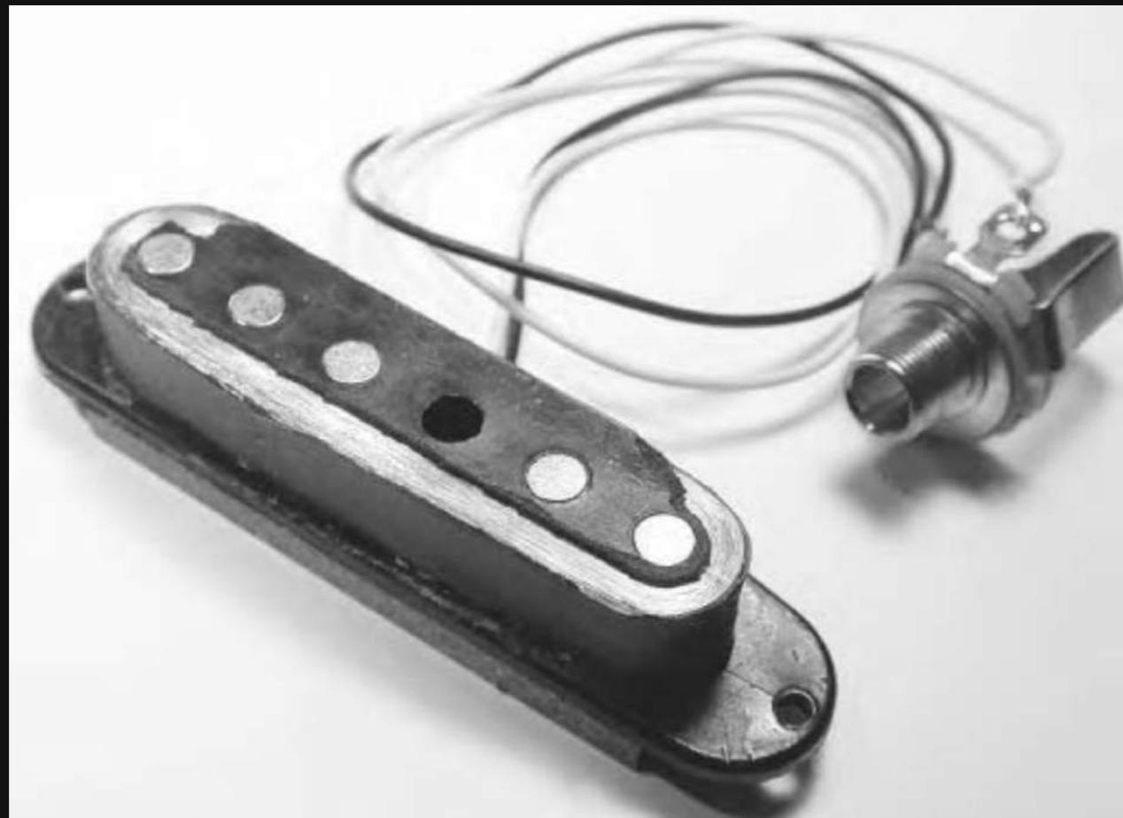
磁铁和线圈可以感应电磁场，并将电磁反应通过放大电路发声
