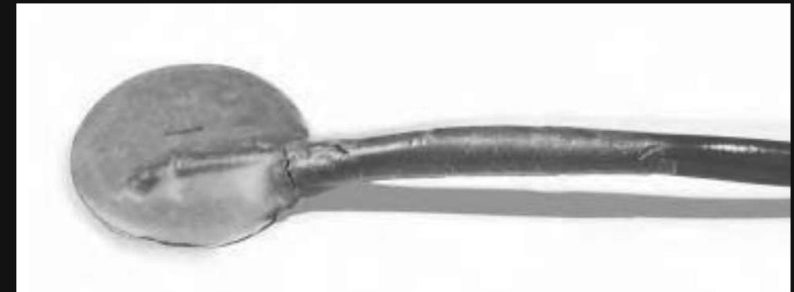
接触式麦克是放大微小声音的利器，和震动的物体接触可以听到隐藏的声音
