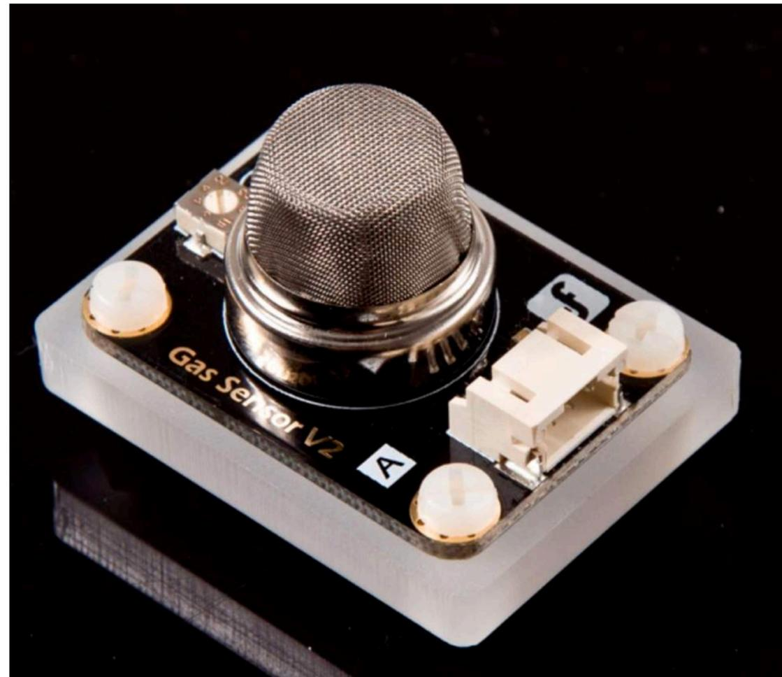
该款气体传感器是基于气敏元件的MQ2气体传感器，可以很灵敏的检测到空气中的烟雾、液化气、丁烷、丙烷、甲烷、酒精、氢气等气体
