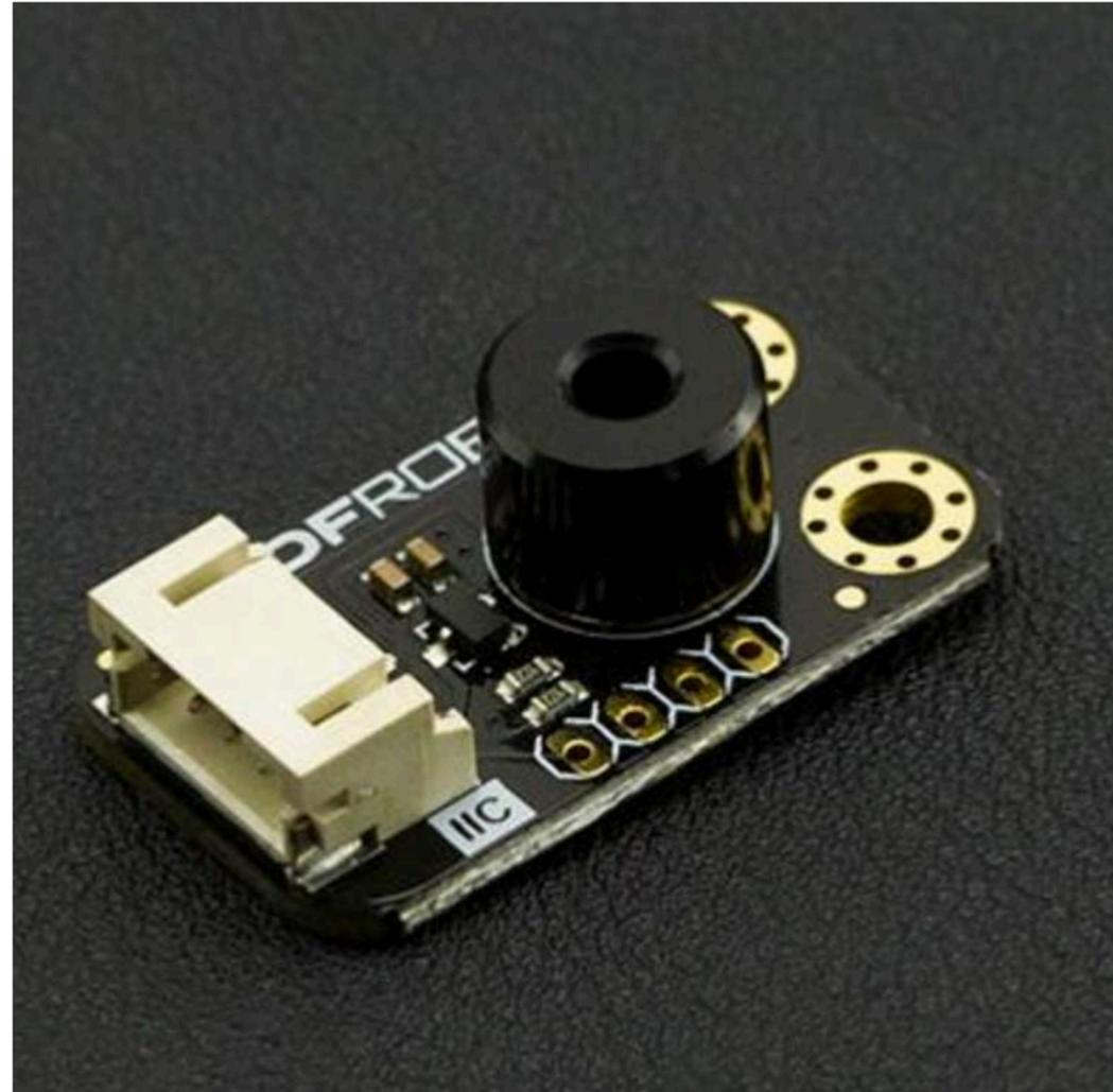
MLX90614红外测温模块，通过探测物体红外辐射能量的大小和波长的分布来检测物体的表面温度。温度范围：-70.01°C至+382.19°C，分辨率0.01°C
