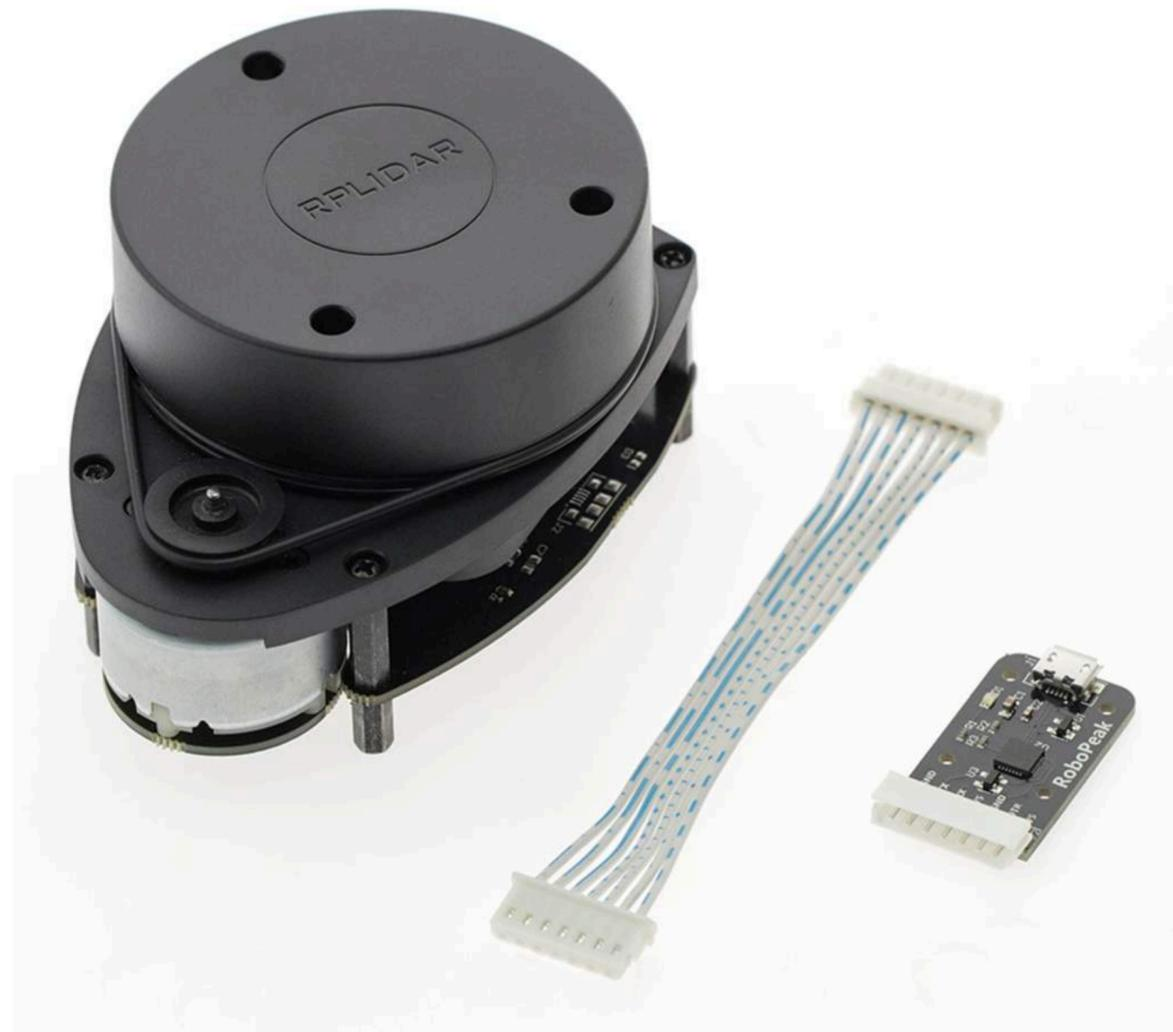
RPLIDAR A2 可以实现在二维平面的 8 米半径范围内进行 360 度全方位的激光测距扫描，并产生所在空间的平面点云地图信息。
