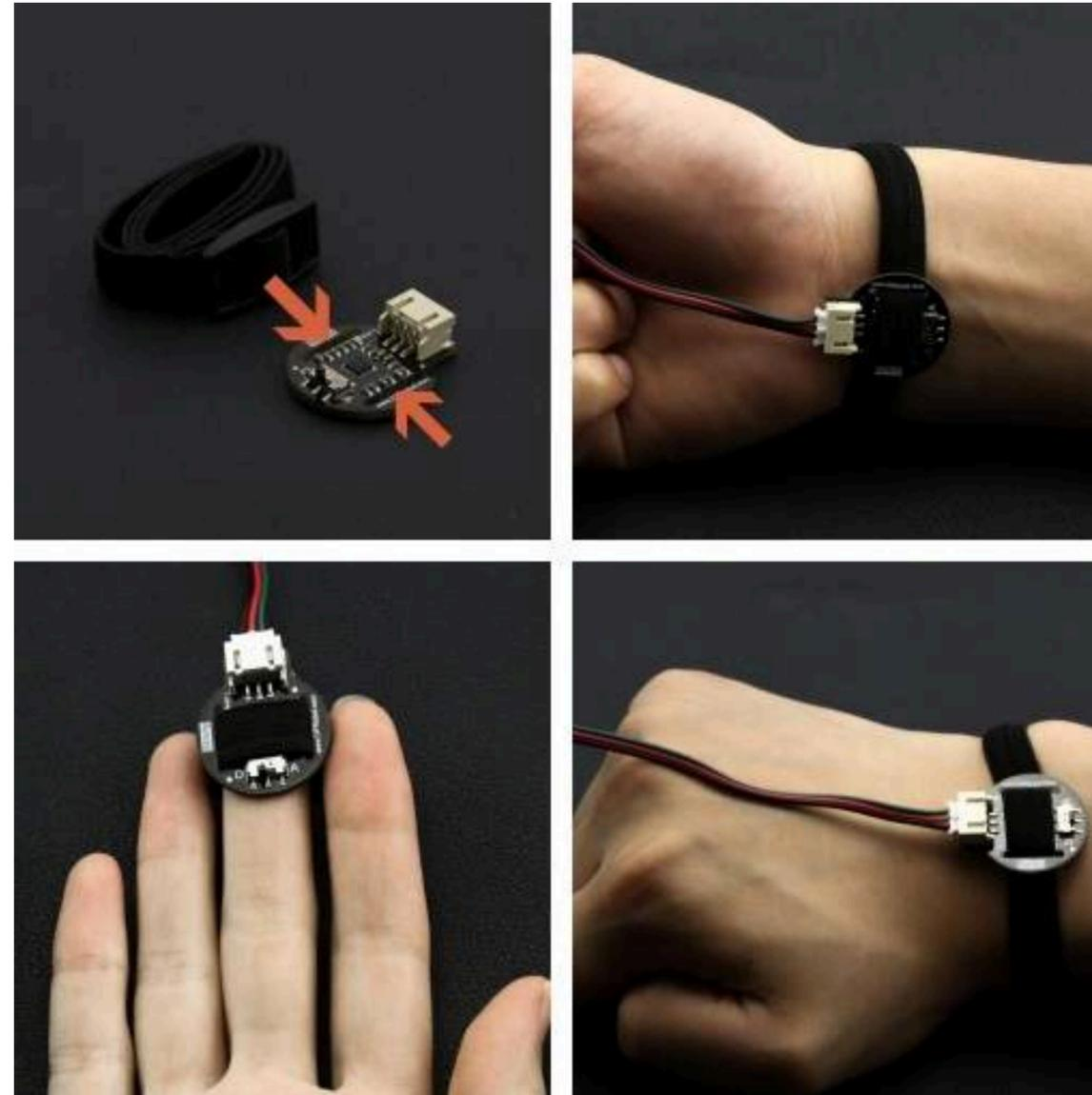
传感器采用PPG光电容积脉搏波描记法(PhotoPlethysmoGraphy)测量心率。这是一种低成本光学技术，通过检测皮下毛细血管内的血氧量变化量来检测对应的人体心率。
