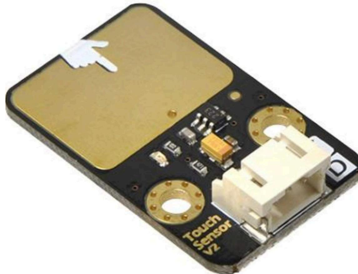
触摸开关是基于电容感应原理。
