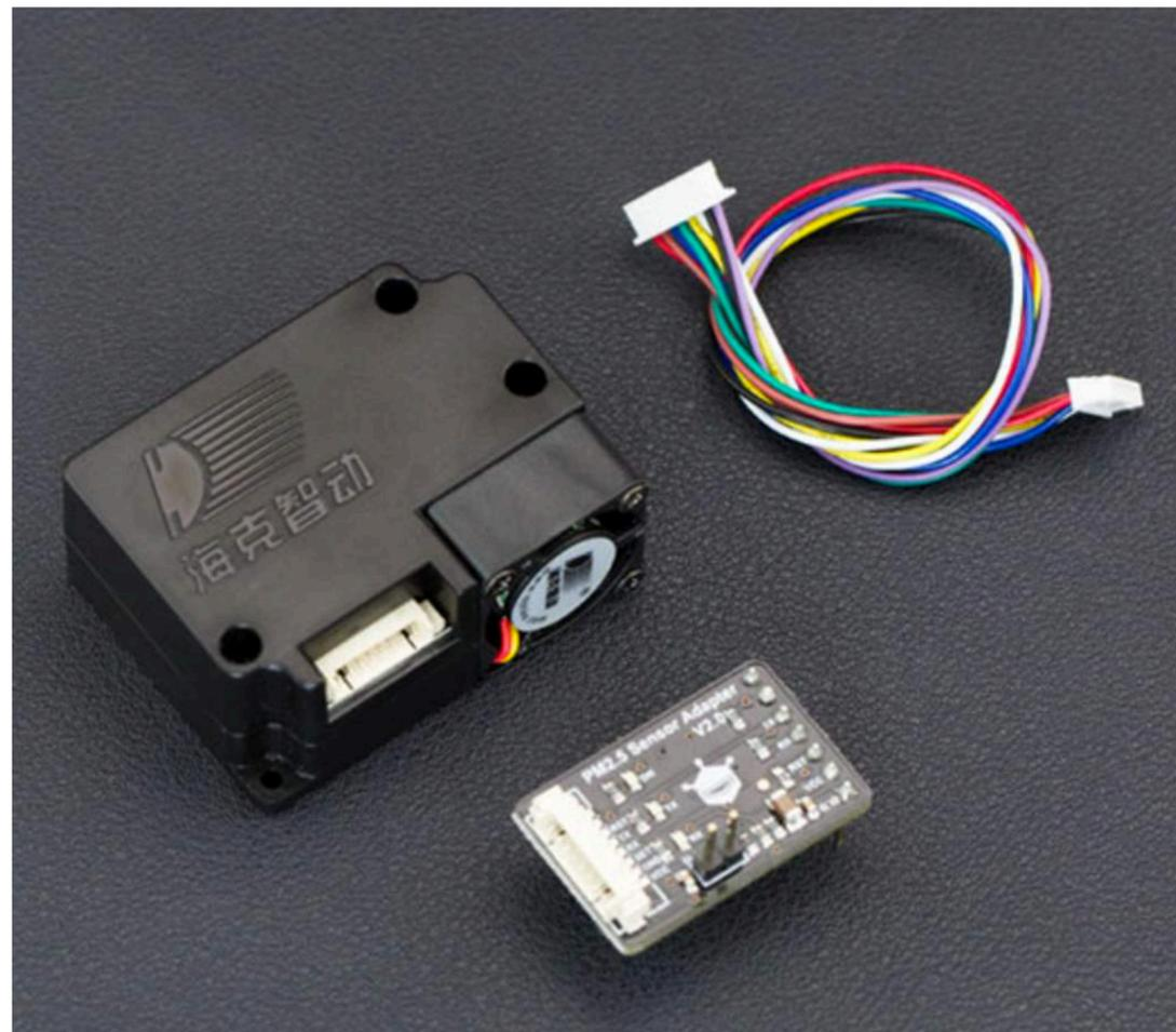
传感器采用激光数字式通用颗粒物浓度传感器，可以用于获得单位体积内空气中0.3~10微米悬浮颗粒物个数，即颗粒物浓度。
