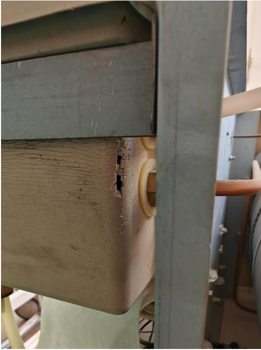
Rotura do depósito do autoclave da ABH e o novo autoclave colocado na esterilização do bloco de ortopedia
