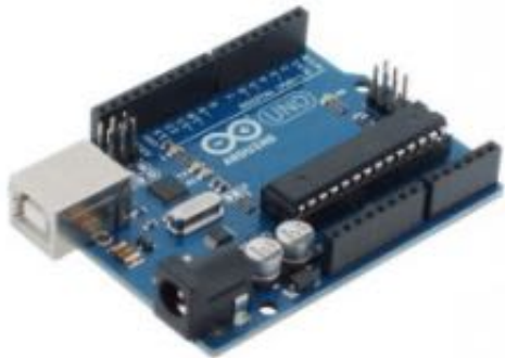
Carte microcontrôleur de type Arduino
