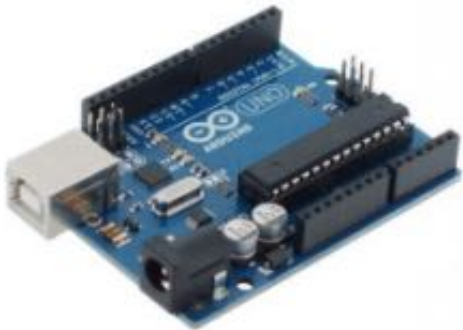
Carte microcontrôleur de type Arduino
